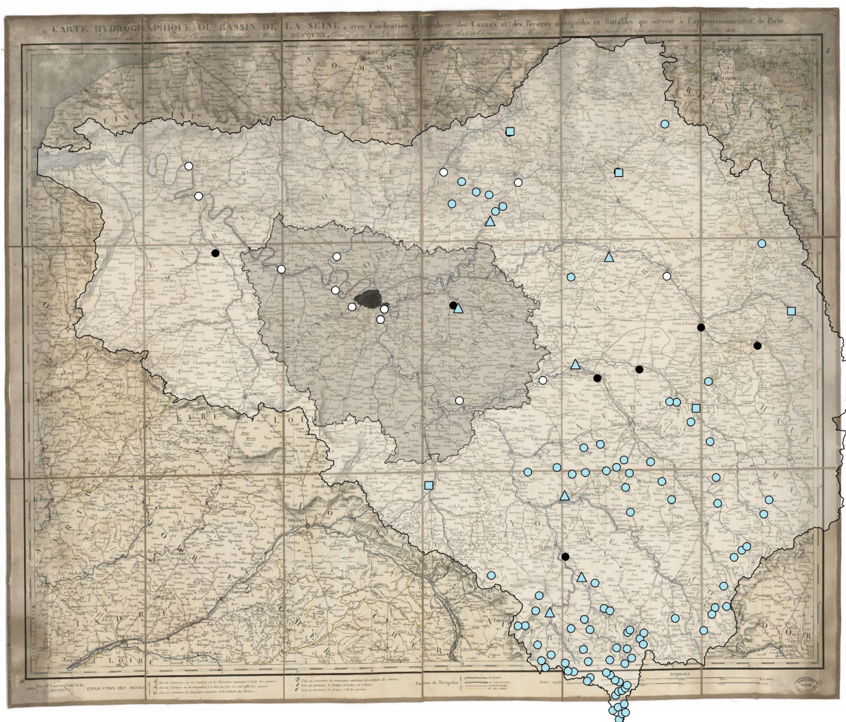
Figure 3. Carte hydrographique du bassin de la Seine, avec indication précise des canaux et des fleuves navigables et flottables qui alimentent Paris, 1828. Légende : cercle blanc — bureau d'octroi de la navigation, cercle noir — lieux navigables, cercle bleu — flottage à bois perdu, triangle bleu — flottage en train de bois à brûler, carré bleu — flottage en train de sciage. Illustration : Sliwinska, 2025 ; Carte : AN/F/14/10078/1/68.
